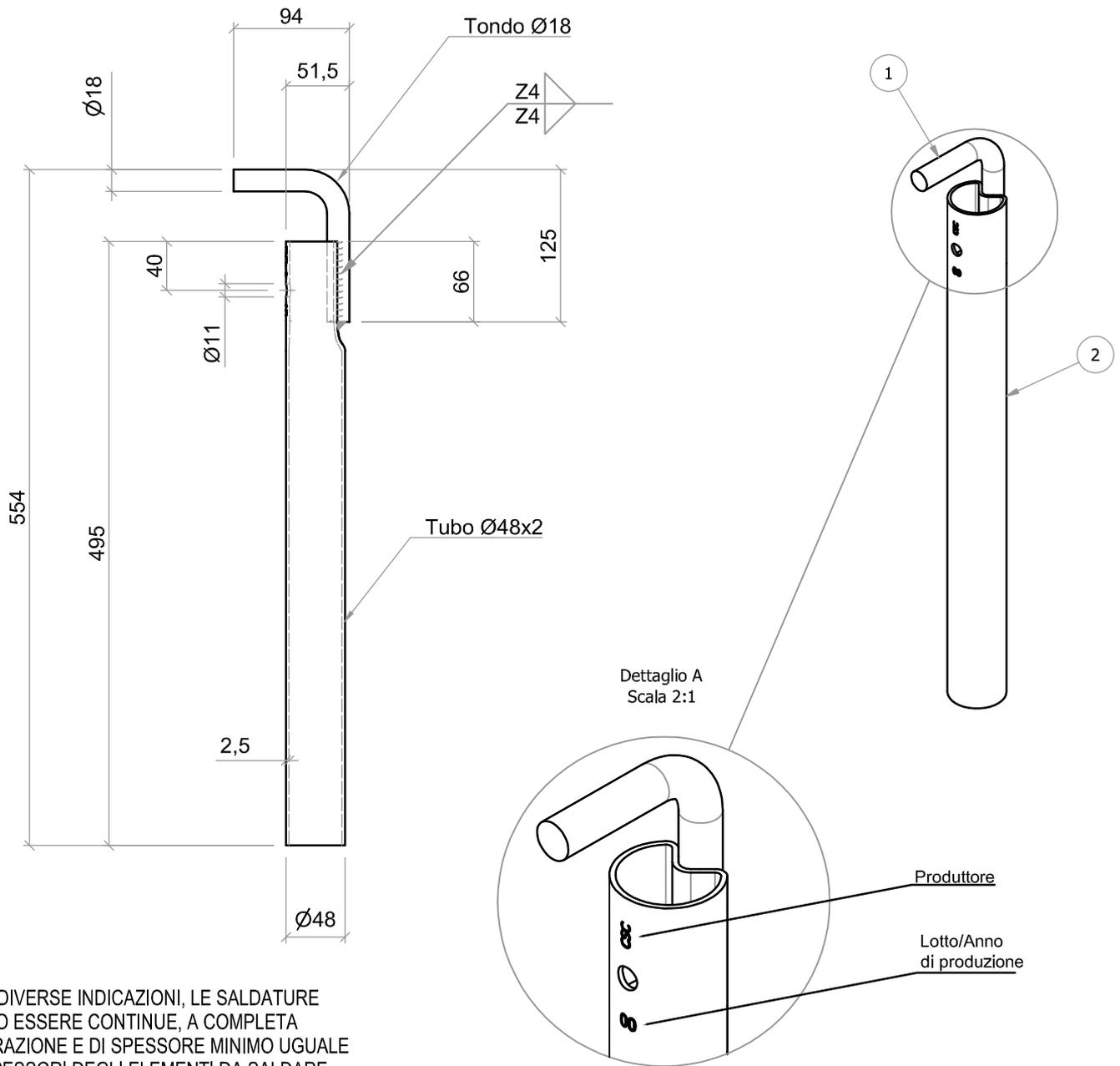
SALVO DIVERSE INDICAZIONI, LE SALDATURE DEVONO ESSERE CONTINUE, A COMPLETA PENETRAZIONE E DI SPESSORE MINIMO UGUALE AGLI SPESSORI DEGLI ELEMENTI DA SALDARE.
